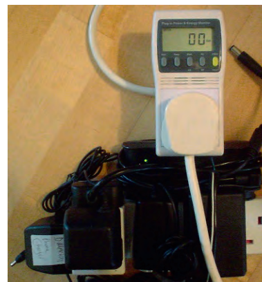
Fot. 11.2. Tych pięć ładowarek – trzy do telefonów komórkowych, jedna do kieszonkowego komputera i jedna do laptopa – pobiera poniżej 1 wata, co widać na moim mierniku zużycia prądu.
