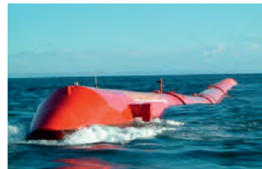
Fot. 12.1. Kolektor energii fal Pelamis to rodzaj węża morskiego składającego się z czterech części. Jest ustawiony przodem do nadbiegających fal. Fale powodują, że wąż wygina się, co porusza generatory hydrauliczne. Maksymalna moc uzyskiwana z jednego węża wynosi 750 kW; w najlepszych lokalizacjach na wybrzeżach Atlantyku jeden wąż może dostarczać średnio 300 kW. Fot. Pelamis www.pelamiswave.com
