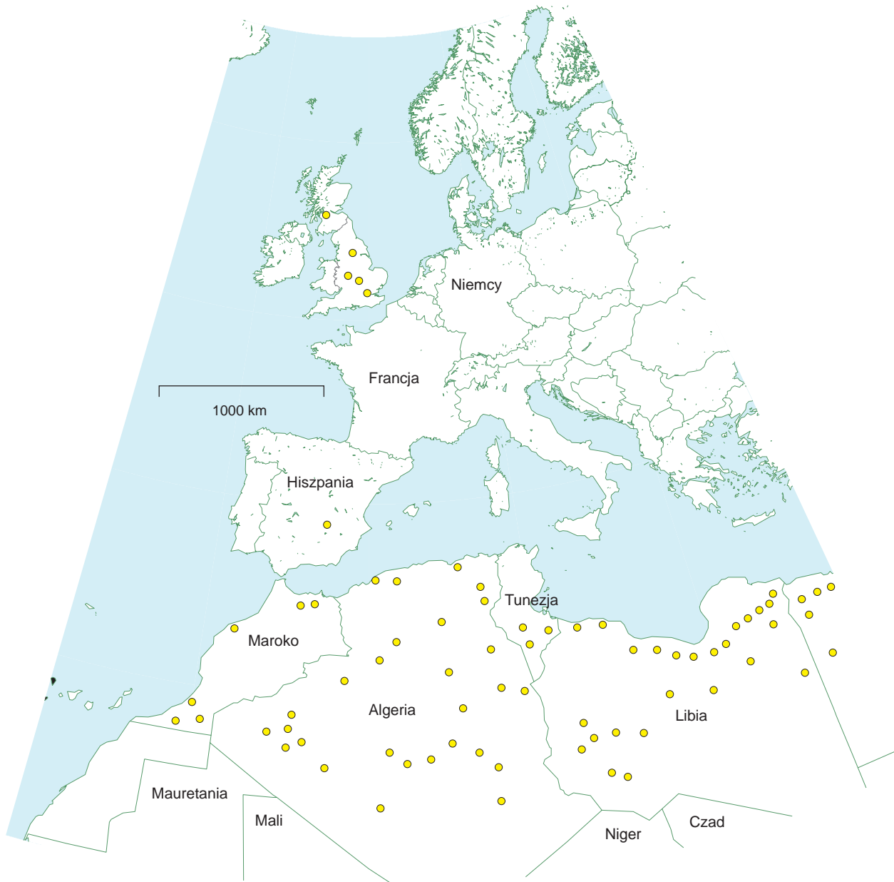
Rys. 25.8. Każda strefa odpowiada obszarowi wielkości 1500 km 2 , który – w połowie wypełniony instalacjami solarnymi – produkowałby średnio 10 GW. 65 takich stref zapewniłoby dziennie 16 kWh na osobę miliardowi ludzi.
