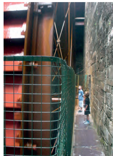
Fot. 8.4. Koło wodne o mocy 60 kW
