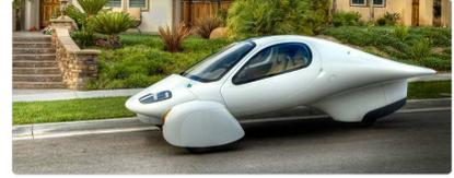
Abbildung 12. **Gut:** Der APTERA. 6 kWh pro 100 km. Foto von [www.aptera.com](http://www.aptera.com).
