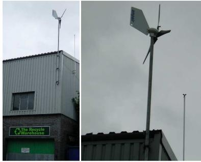
Abbildung 14. **Schlecht:** Windgeneratoren auf dem Dach. Die durchschnittliche Leistung, die von diesem Ampair „600 W“-Windgenerator in Leamington-Spa erzeugt wird, beträgt **0.037 kWh pro Tag** (1.5 W).
