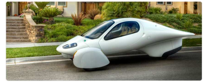
Рис. 12. Варто: Прототип електромобілю компанії Aptera. Енергоспоживання – 6 кіловат-годин на 100 км. www.aptera.com .
