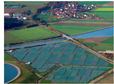
Fot. 6.7. Farma słoneczna z ogniwami fotowoltaicznymi: Park Słoneczny w Mühlhausen w Bawarii o mocy szczytowej wynoszącej 6,3 MW. Średnia moc na jednostkę powierzchni jest szacowana na około 5W/m 2 .
